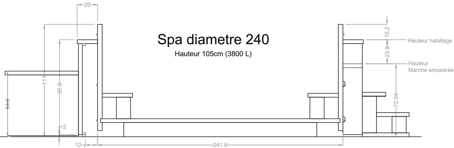
L'habillage doit impérativement reposer sur le plancher fini.
